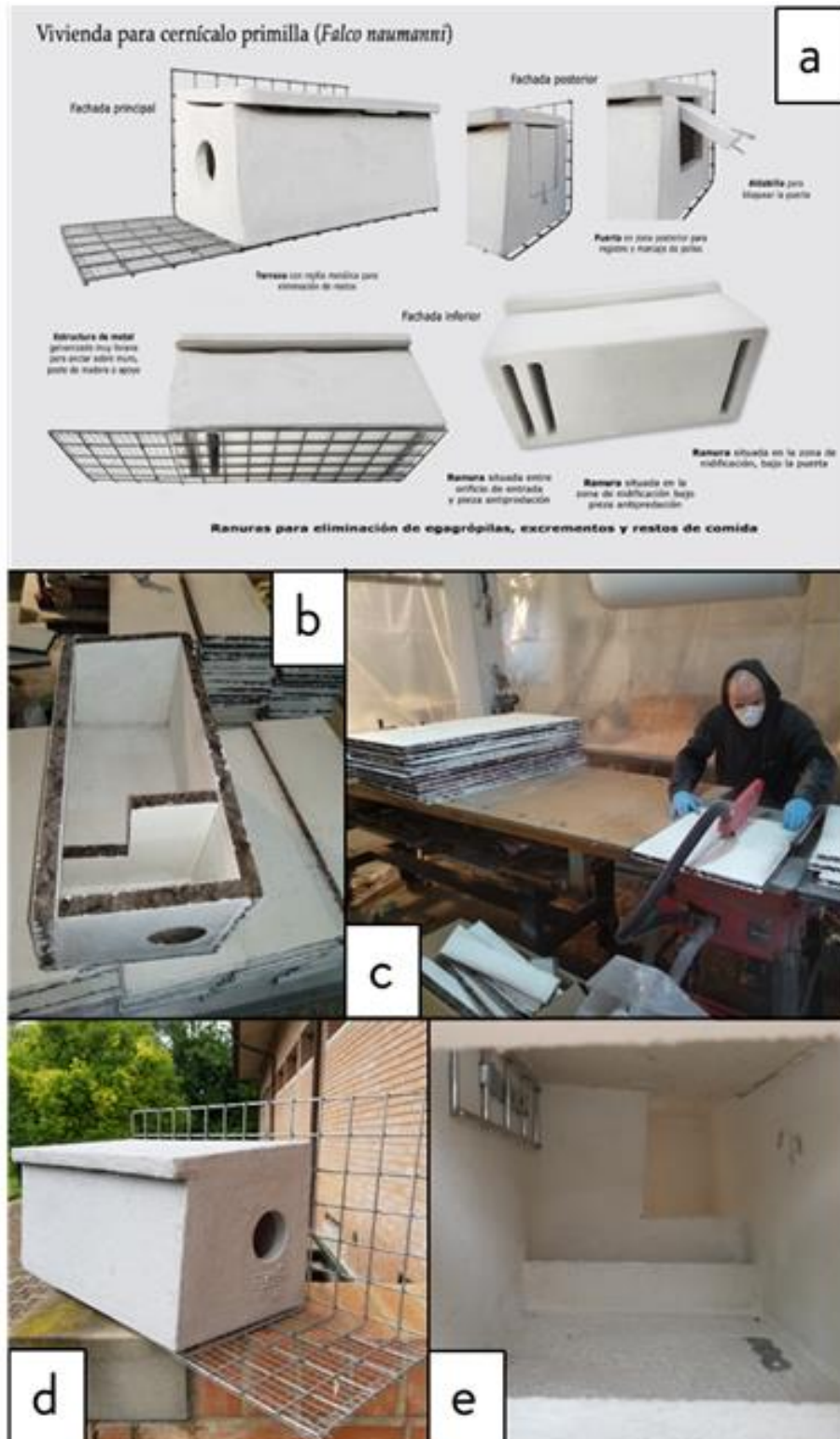
Figura 6. Cassetta nido progettate da LIFE FALKON e prodotte da DEMA per essere installate sugli edifici. Le cassette nido sono state prodotte nei colori grigio chiaro, bianco e rosso chiaro per adattarsi ai diversi stili architettonici delle aree studio. Nella figura: a) aspetto generale e principali elementi strutturali delle cassette nido; b) sezione interna in vista frontale di una cassetta-nido in costruzione; c) realizzazione delle pareti della cassetta nido in calce-sughero; d) cassetta nido completa con vista del foro di ingresso laterale; e) interno di una cassetta nido completata vista dallo sportellino laterale.
